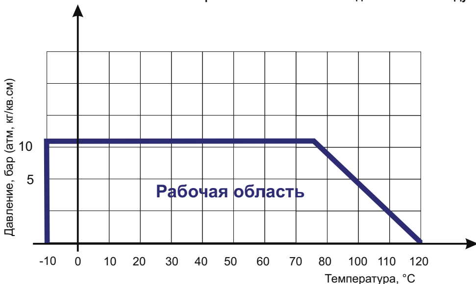
Диаграмма Давление / Температура для задвижки клиновой ABRA-A40-10G с обрезиненным клином и невыедным штоком Ду200-600 Ру10:
