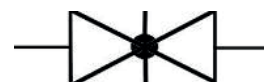
Вариант 4. Знак "Задвижка клиновья или шиберная" Шаровой кран так обозначать неверно, но обозначают так часто.
