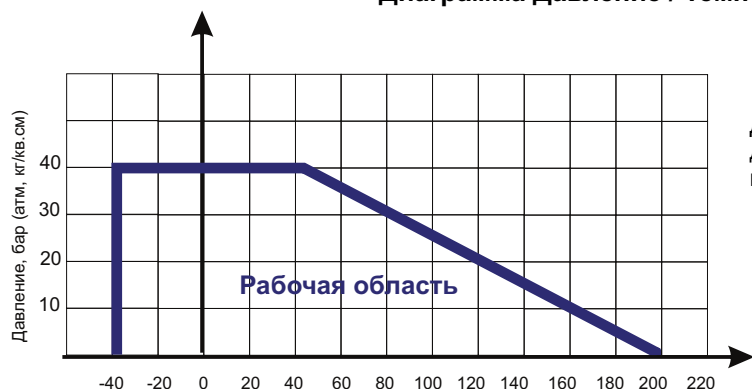
Диаграмма Давление / Температура для шарового крана ABRA-BV-027A
