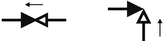
Условное графическое изображение обратного клапана на чертежах и схемах
