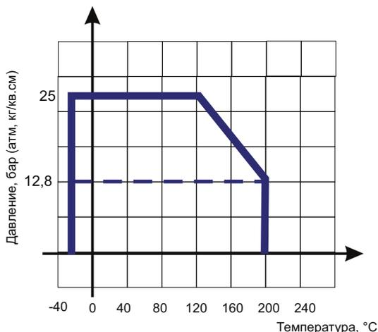
Диаграмма определяет рабочую область для обратного клапана тарельчатого межфланцевого ABRA-D71 в координатах Давление (в барах приборного) / Температура (°C).
