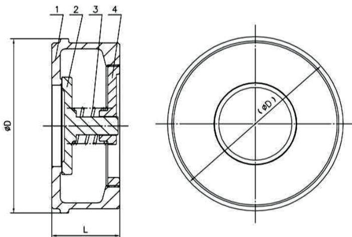
Габаритные размеры, рабочие давления, температуры, вес и давление открытия обратного клапана тарельчатого межфланцевого ABRA-D71. Размеры в мм.
