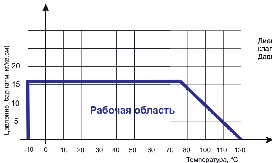
Диаграмма Давление / Температура для клапана обратного ABRA-D-122
