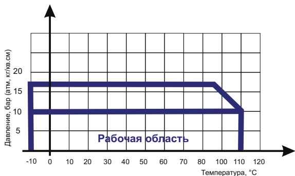
Диаграмма Давление / Температура для затвора поворотного дискового ABRA-BUV-FL226Dxxx Ду32-600, Ру 10 и Ру 16
