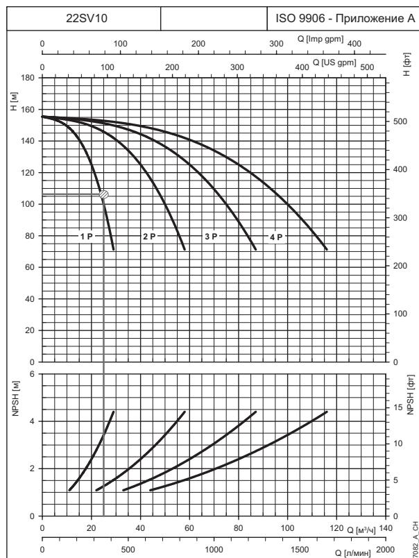
В приведённом рядом примере в качестве исходных данных берутся расход  $22 \text{ м}^3/\text{ч}$  и давление  $110 \text{ м вод. ст.}$
