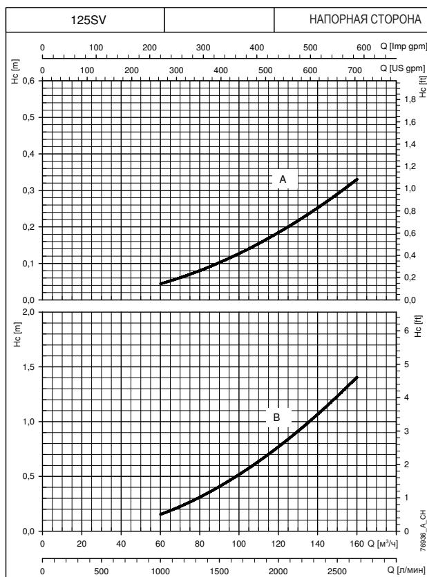
Характеристики приведены для жидкостей с плотностью  $\rho = 1,0 \text{ кг/дм}^3$  и кинематической вязкостью  $v = 1 \text{ мм}^2/\text{сек}$ .
